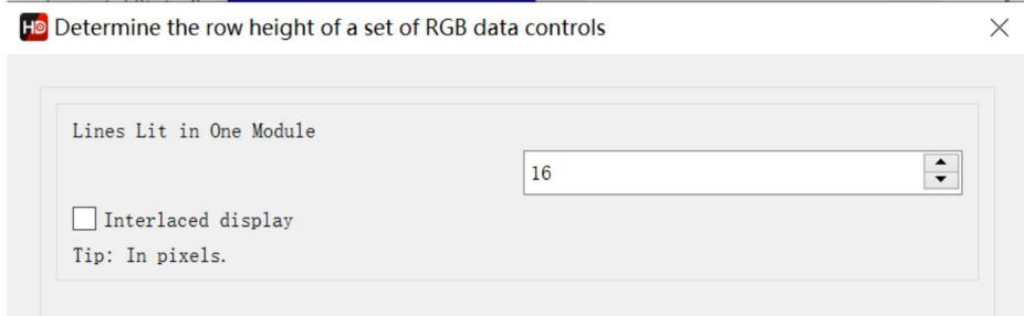
La siguiente figura muestra el sexto paso de la configuración inteligente. Por favor observar el desempeño del módulo y completar los valores correspondientes. Este paso es para probar el tipo de escaneo.
