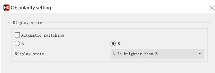
La siguiente figura muestra el cuarto paso de la configuración inteligente. En este paso, intente seleccionar el estado A, B, C, D para observar la pantalla a color del módulo. Según el rendimiento del módulo, seleccione la opción correspondiente en el estado de visualización. Este paso es para determinar el canal de color del módulo.
