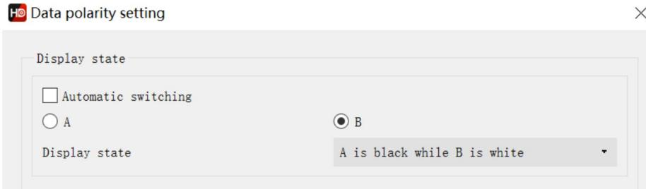
La siguiente figura muestra el tercer paso de la configuración inteligente. En este paso, intente seleccionar AB para observar el brillo del módulo. Según el rendimiento del módulo, seleccione la opción correspondiente en el estado de visualización. Este paso es para determinar la polaridad OE.
