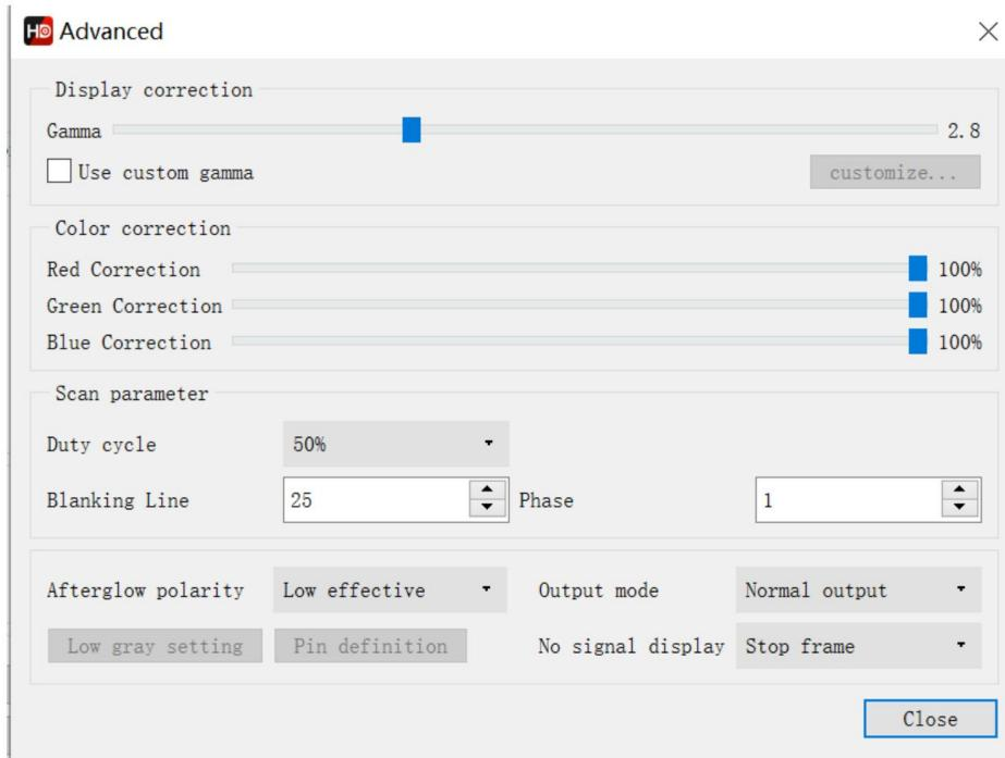
Canal de color: el color rojo, verde y azul de la pantalla se puede cambiado mediante la depuración.
